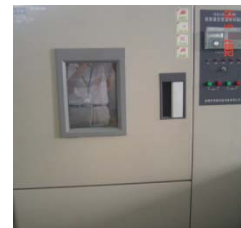
Прибор тестирования по температуре
