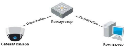
Рисунок 3-2 Соединение через коммутатор или роутер
